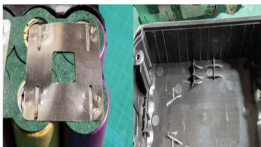
バッテリータブ溶接の 品質が安定していない
